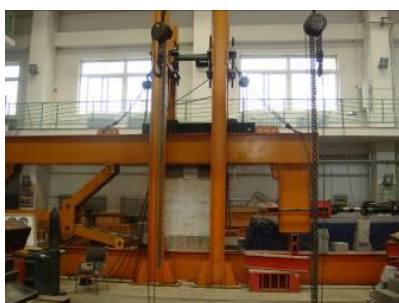
图 4.2 四连杆加载装置
