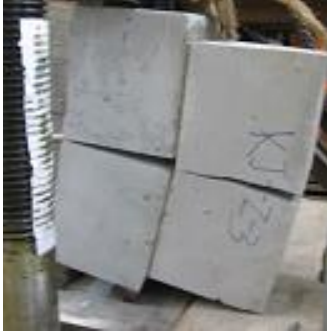
图 3.6 专用砂浆侧面弯断破坏
