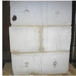
图 3.1 KY-P 组试件裂缝图
